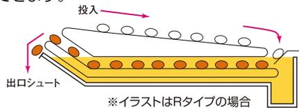
食材の投入を出口シュート側または本体中央で行うタイプ。作業する方がひとりの場合でも、食材をコンベアにセットしながら、出口シュートより搬出される食材を受け取ることができます。
