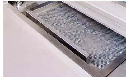
洗浄槽上部ストレーナー
