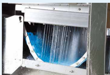
超高压ノズルからのパワフルな水流が汚れを落とします。
