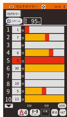
10段タイプのスーパースチームの場合、タッチパネルにも10段分のタイマーを表示します。そのため、例えば3段目に食材を投入した場合は、タッチパネル上でも3段目のタイマーを設定することで、どの段にどのタイマーを使用しているかがひと目でわかり便利です。
