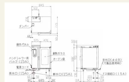
■保守点検のためにメンテナススペース(後方30cm/左側面50cm)を設けて設置してください。
