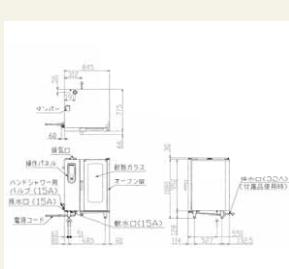
●保守点検のためにメンテナンススペース(後方30cm/左側面50cm)を設けて設置してください。
