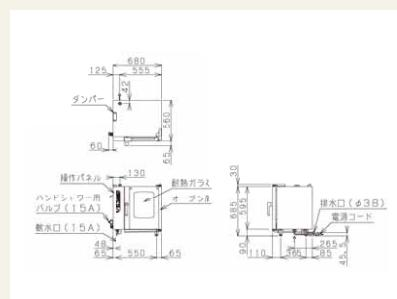
●保守点検のためにメンテナンススペース(後方30cm/左側面50cm)を設けて設置してください。
