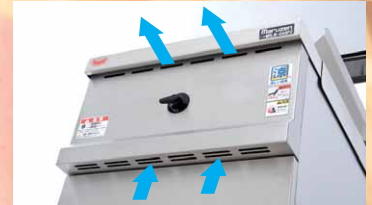
矢印のように空気が流れることで、本体前面上部の熱を奪う。
