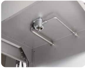
冷却室 (上ノズルを外した状態)
