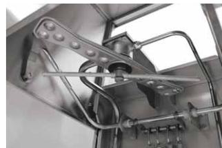
▲新型すすぎノズル(写真は下すすぎノズル) ▲天井からの“あとだれ”を防ぐ上すすぎノズル
