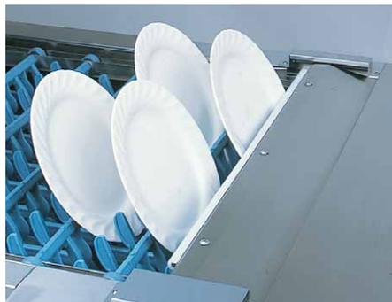
取りそねた食器をセンサーが感知し、コンベアの回転を自動的に停止します。大切な食器を破損することなく、安全に作業できます。また、洗浄室内でシルバー等が引つ掛かった場合も安全装置が作動して、コンベアの破損を防ぎます。
