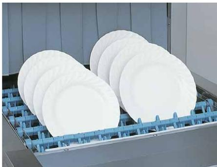
コンベア部分に斜に設置したフライト(つめ)が食器類をしっかり固定。陶器類や高級食器も安心して洗浄できます。コンベアは大皿の洗浄も可能な600mm幅で、表面がフラット設計なので各種専用ラックをそのまま乗せられます。
