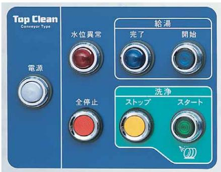
洗浄スタート/ストップはスイッチを押すだけの簡単操作。また、洗浄槽の湯が少なくなった場合には「水位異常」ランプが点灯して、洗浄機を自動停止、洗浄ポンプや加熱装置を保護します。
