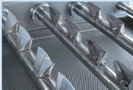
マルゼン独自設計の扇型ノズルがナイフエッジ高圧噴射を可能にします。食器に対して最も効果的な角度で噴射され、ムダがなくパワフルに、そしてスピーディに洗い上げます。
