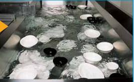
かき上げ槽での浸漬効果と噴流ポンプによる水流で汚れを落ちやすくします。噴流ポンプの水流により、食器はコンベア部に集められます。ゴミは噴流ポンプ前のゴミ受けに集まるので、清掃もラクに行えます。
