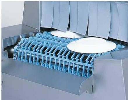
万一食器が狭まった場合でも、センサーが感知してシュートリミットを作動させ、洗浄機の運転を自動で停止します。食器の破損やネットの損傷を防ぎ、安全に作業できます。また、洗浄室内でシルバー等が引っ掛かった場合も安全装置が作動して、コンベアの破損を防ぎます。
