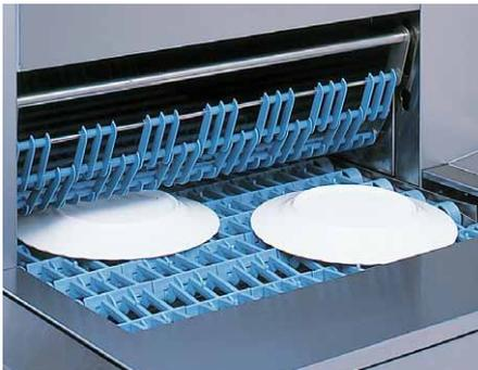
ネットが上下からやさしく、しかも確実に食器類を固定するWコンベアネット方式。上下からの超高圧噴射にも食器は飛ばされず、汚れをしっかりと落とします。コンベア幅は620mmと830mmの2パターンあり、洗浄する食器の量や大きさに合わせて選べます。食器にソフトで熱に強いデルリン樹脂製の網目ネットは、1チップごとの着脱が可能で、メンテナンスが楽に行えます。
