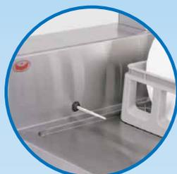
洗浄機から出てきたラックがストッパーに当たると洗浄機を自動的に停止状態にし、ラックを取り除くと再始動します。無駄な電気やすすぎ湯の消費を抑え、ラック送り装置の消耗を抑えます。
