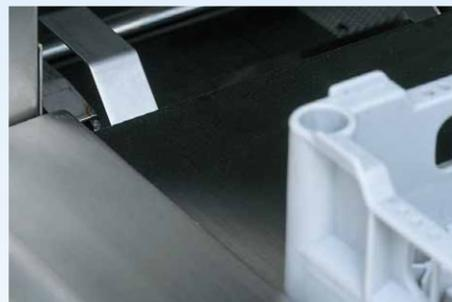
コンベア入口にラックを挿入すると、スターターが検知して自動的にラックを搬送し、自動的に洗浄を開始します。
