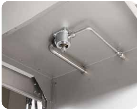
冷却室 (上ノズルを外した状態)
